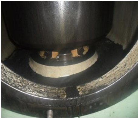
Gambar 3.7. Deposit karbon di saluran udara bilas (scavenge ports)
